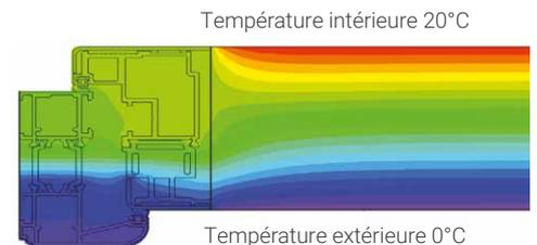
**Thermique** : calcul réalisé selon la norme EN ISO 10077-1 et -2 sur porte pleine avec dimension d'ouvrant de 2350 x 1070 mm et rejet d'eau. **AEV** : essais réalisés selon la norme NF P 20-501. N°404/2019/243-1 du 06/12/2019. **Ensoleillement** : selon norme NF EN 12219. **Acoustique** : Classification selon la norme ISO 717-1 sur porte pleine de dimension HT 2180 x 960 mm.
